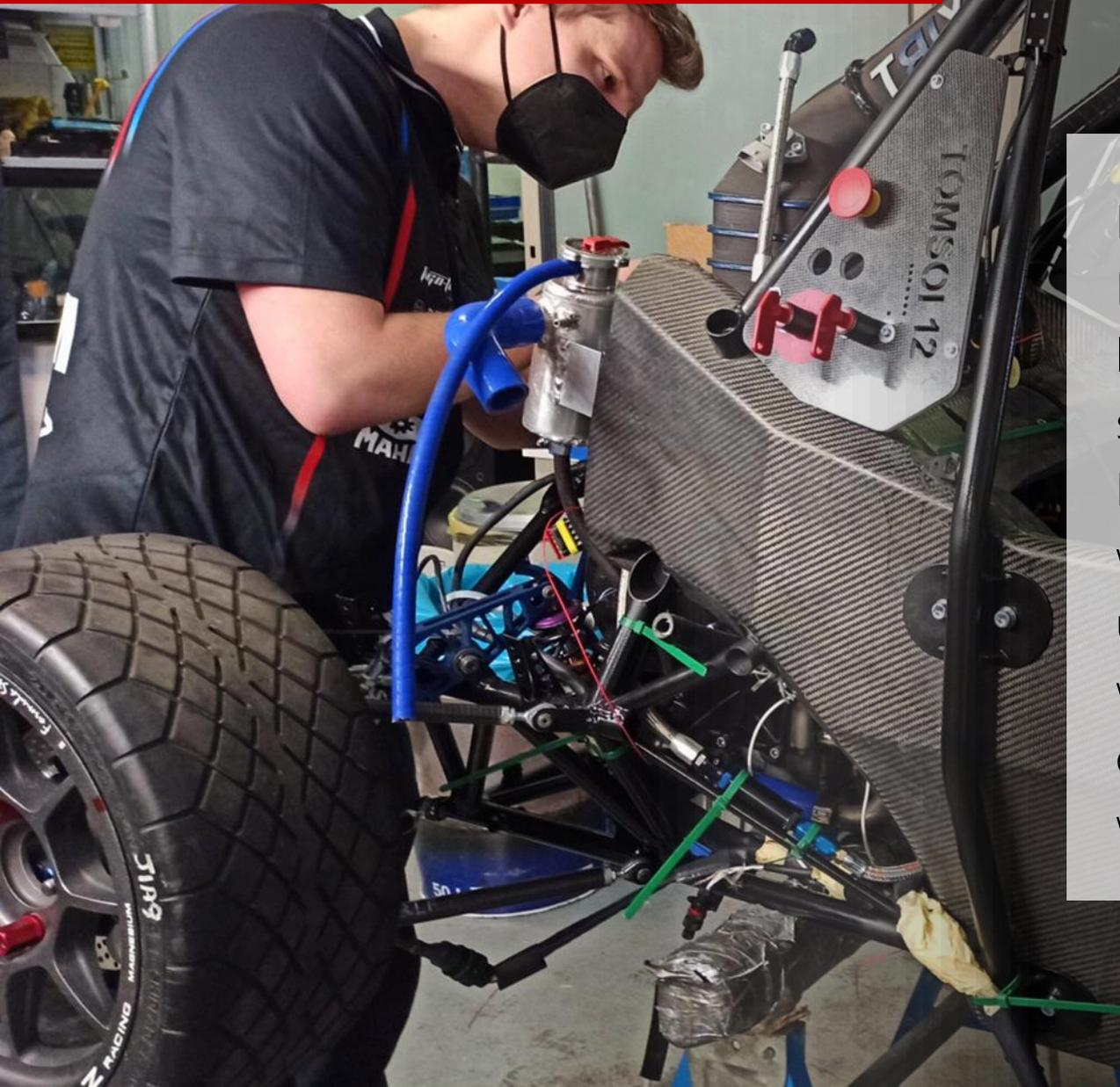
Es fehlen nur noch wenige Teile, dann ist unser zwölfter Rennwagen bereit für seine erste Testfahrt! In den letzten Monaten wurde mit großer Motivation geschraubt, geschweißt, laminiert und montiert. Neben Heckrahmen, Fahrwerk und Motor sind bereits alle wichtigen Komponenten wie das elektrische System und das Bremssystem installiert worden. Nun arbeiten wir voller Vorfreude auf den Tag hin, an dem wir zum ersten Mal unsere Runden drehen und den Rennwagen testen können.
